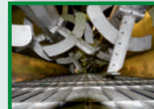
Rührwerke 2-4 U/min mit selbstreinigendes Spezialsieb
